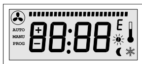
Figuré 6. Affichage de tous les segments après la mise sous tension
