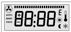
Abb. 6. Aktivierung aller Displaysegmente nach dem Einschalten
